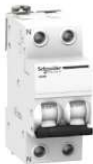
INTERRUPTOR TERMOMAGNÉTICO DISPOSITIVO DE CORTE DE CORRIENTE CAPAZ DE DETECTAR UNA SOBRECARGA O UN CORTOCIRCUITO Y ACTUAR INMEDIATAMENTE DESCONECTANDO LA ENERGÍA
