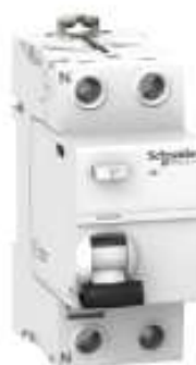
INTERRUPTOR DIFERENCIAL DISPOSITIVO DE CORTE CAPAZ DE DETECTAR UNA FUGA DE CORRIENTE, DESCONECTANDO INMEDIATAMENTE LA ENERGÍA. SU COMETIDO PRINCIPAL ES LA PROTECCIÓN DE LAS PERSONAS
